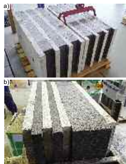
Fot. 1. Prototypowe wersje elementu murego zaproponowanego przez: a) firmę EKOBUD; b) zespół UTP
