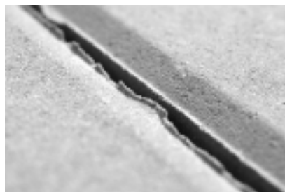
Fot. 10. „Korona” na krawędzi elementu wynikająca ze zużycia formy i stempla
