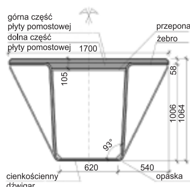
Rys. 3. Przekrój poprzeczny kompozytowego mostowego dźwigara
