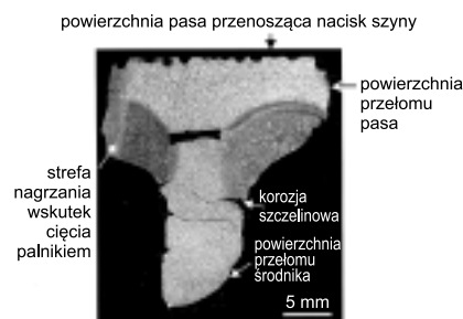
Rys. 4. Pęknięcia zmęczeniowe środka belki wskutek cyklicznego jego zginania z płaszczyzny
