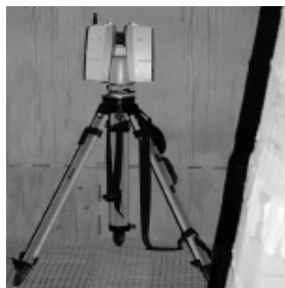
Fot. 1. Skaner laserowy Leica ScanStation C10 w trakcie pomiaru [Fot. E. Puniach]
