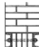
Rys. 4. Nadproże stalowe z wypełnieniem murem
