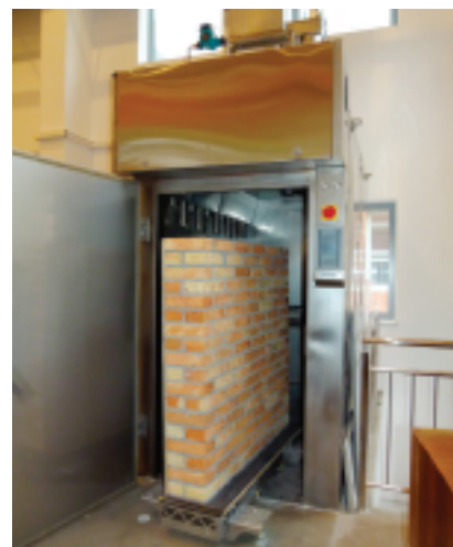
Fot. 2. Komora do kondycjonowania próbek murów w skali 1:1
