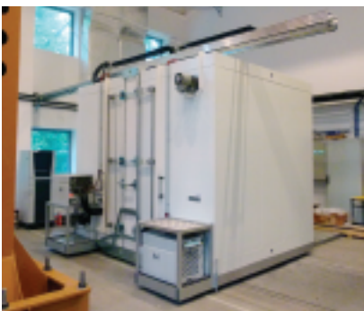
Fot. 1. Komora do badań ciepłno-wilgotnościowych typu Hot Box Taurus TDW 4040
