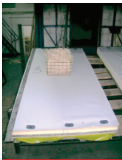
Badanie odporności dachu na ogień zewnętrzny (czyli „rozprzestrzeniania ognia”) metodą 1 wg PN-ENV 1187. Podczas badania ocenia się zachowanie konkretnego elementu, poddanego działaniu ognia, powstałego podczas spalania 0,6 kg wełny drzewnej
