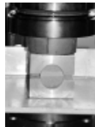
Fot. 1. Badania na ściskanie zaprawy w odwiercie walcowym
