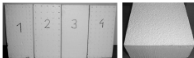
Rys. 1. Przykładowe próbki badawcze z powłoką elewacyjną z akrylowej masy tynkarskiej (źródło: [1])
