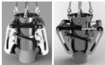
Fot. 2. Urządzenie do obróbki głów pali podczas pracy
