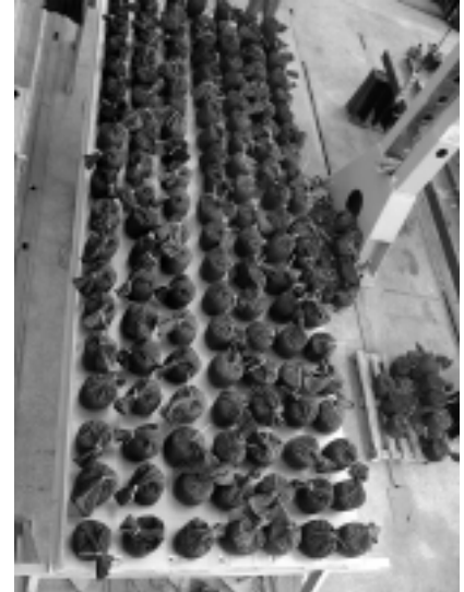
Symulowane obciążenie równomierne woreczkami wypełnionymi piaskiem
