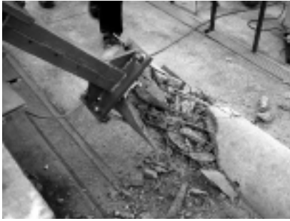
Fot. 2. Zniszczenie wierzchołkowej części żerdzi wirowanej typu E w próbie na skręcanie ze zginaniem
