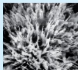
Zdjęcie wykonane na głębokości 5 cm po 26 dniach od nałożenia XYPEX-u na powierzchnię próbki betonowej
