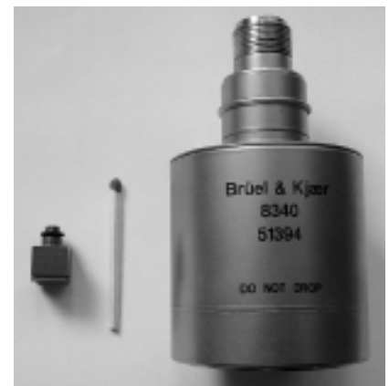
Fot. 1. Akcelerometr uniwersalny i sejsmiczny (z prawej) Fot. J. Groseł
