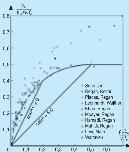
Rys. 4. Zależność nośności na ścinanie od intensywności zbrojenia poprzecznego (wyniki badań na podstawie [6])
