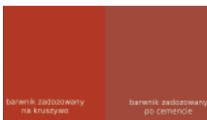
Fot. 3. Wpływ kolejności dozowania barwnika na odcień betonu. Barwnik dodany przed cementem jest lepiej wymieszany i w efekcie daje lepszy efekt
