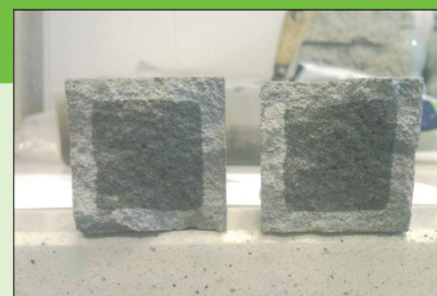
Głębokość wnikania hydrofobizatora EuroCret® HMX
