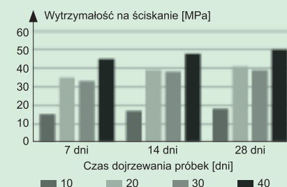
Rys. 5. Wytrzymałość na ściskanie betonów geopolimerowych na bazie spoiwa wytworzonego z popiołów lotnych w przypadku 10, 20, 30, 40% popiołów w objętości mieszanki [10]
