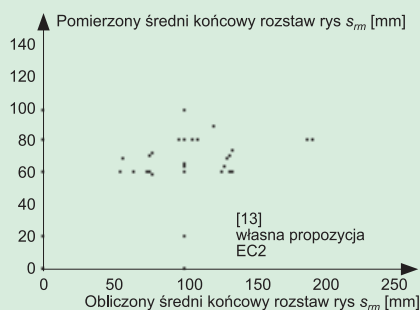
Rys. 5. Porównanie obliczonego średniego końcowego rozstawu rys prostopadłych z wynikami badań [2, 5, 8]
