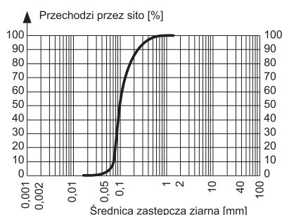
Rys. 1. Krzywa uziarnienia gruntu niespoistego
