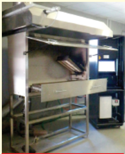
Urządzenie do badania wyrobów podłogowych z płytą promieniującą wg EN 9239-1
