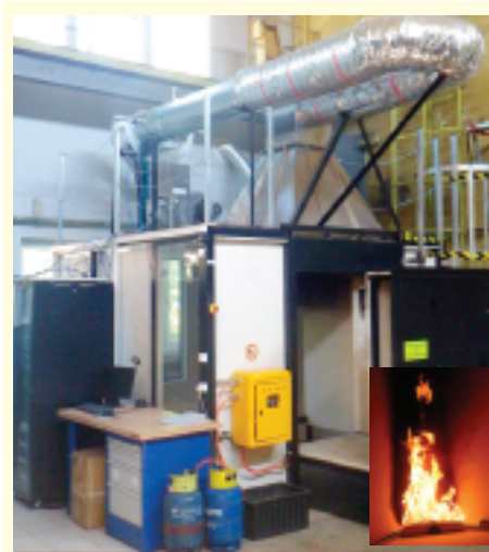
Komora do badania SBI wg EN 13823
