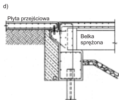
Rys. 4 Przykłady konstrukcji połączenia mostu zintegrowanego z nasypem
