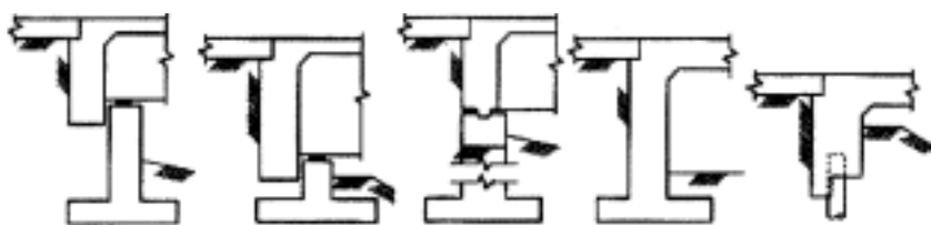
Rys. 3 Schematy przyczółków mostów zintegrowanych
