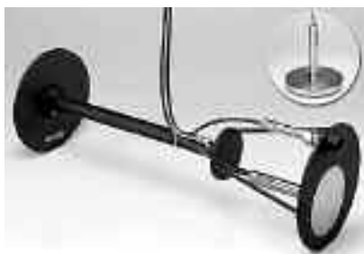
Fot. 2. Czujnik do pomiaru ciśnienia parcia gruntu na ścianę szczelinową
