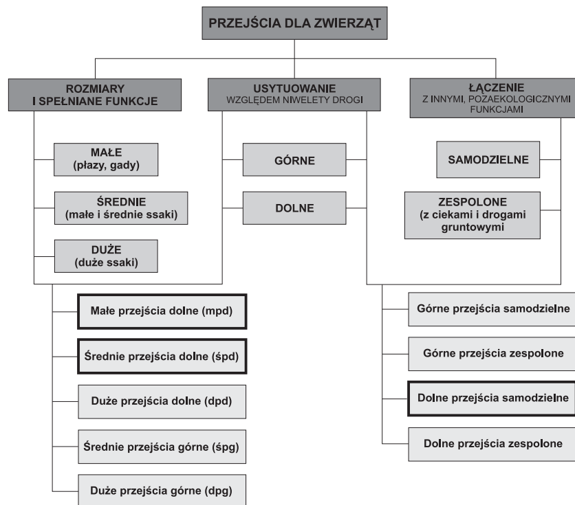
Rys. 2. Podział przejść dla zwierząt. Grubymi ramkami oznaczono typy przejść dla zwierząt budowane najczęściej w infrastrukturze komunikacyjnej jako konstrukcje gruntowo-powłokowe
