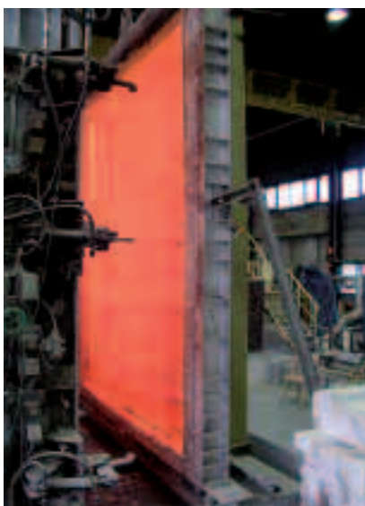
Fot. 2. Ściana z izolacją Stalrock MAX po badaniu ogniowym w laboratorium. Widok od strony źródła ognia. Przegroda zachowuje szczelność i izolacyjność ogniową do 90 minut
