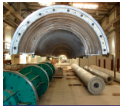
Fot. 6. Hala w Lewinie Brzeskim do produkcji strunobetonowych segmentów wirowanych w formach rozbieralnych
