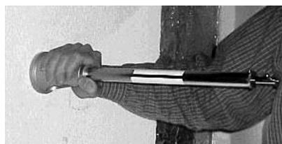
Fot. 4. Badanie systemu ociepleń za pomocą perfortestu
