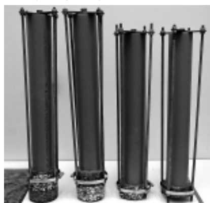
Fot. 3. Stanowisko do badania przesiąkliwości Photo 3. Stand for investigation of wicking.
