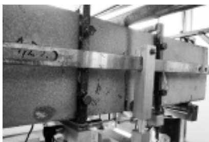
Fot. 3. Przykładowy sposób zniszczenia belki z włóknami stalowymi Photo 3. An exemplary way of destruction beams with steel fibers
