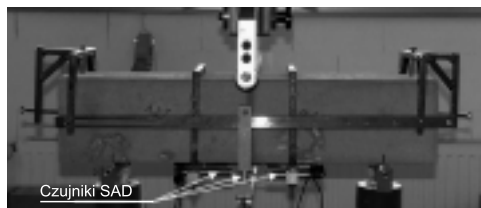
Fot. 1. Sposób podparcia, przyłożenia obciążenia i rozmieszczenia czujników pomiarowych w elementach próbnych
