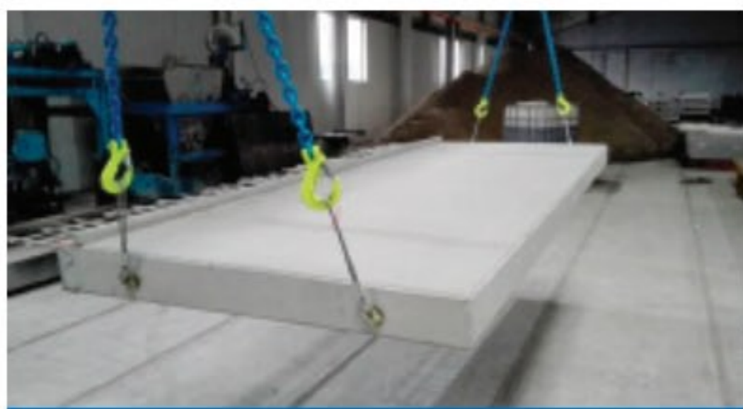
Elementy pełnego balkonu prefabrykowanego pełnego przygotowywane do wysyłki na budowę
