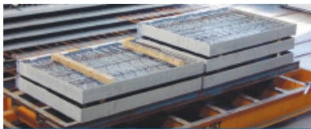
Balkony prefabrykowane typu LEIER-PANEL (z burty-krawędzią) przygotowane do wysyłki
