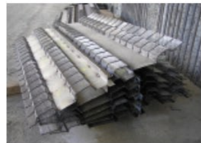
Specjalnie zaprojektowane szalunki Stremaform® do budowy dworca Nowa Łódź Fabryczna
