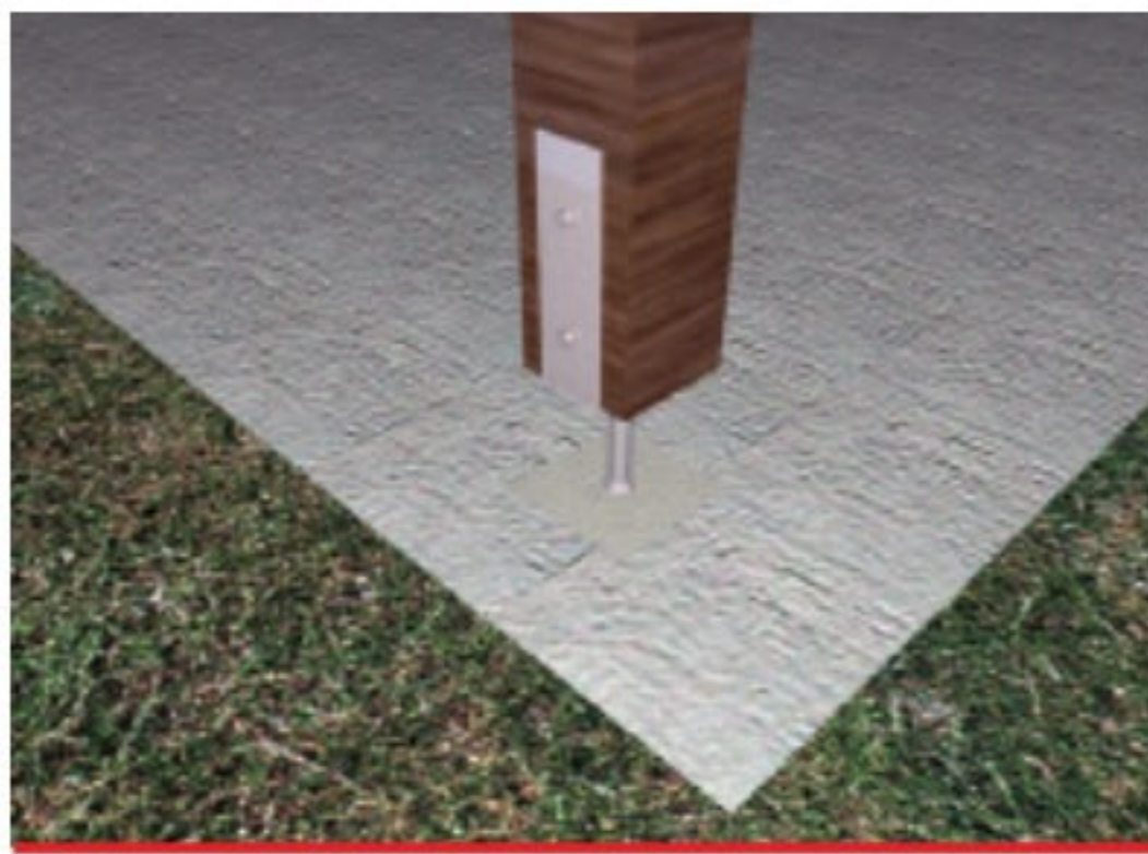
Rys. 1. Zaprawa ATLAS MONTER T-15 zastosowana do montażu kotwy słupka drewnianego w płycie fundamentowej
