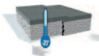
Fot. 1. Rysy w betonie osiągają największą rozwartość zimą, gdy temperatura jest najniższa. W strefie klimatycznej Polski bezpiecznie jest przyjąć temperaturę -20 °C.
