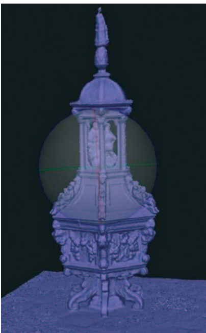
Fot. 3. Trójwymiarowy model chrzcielnicy opracowany za pomocą fotogrametrii (z uwzględnieniem tekstury i bez)
