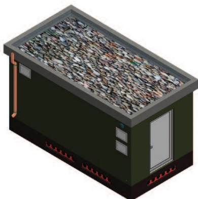
Fot. 3. Wizualizacja kontenera. Dach jest standardowo wypełniony kruszywem naturalnym. Możliwe jest wykonanie tzn. dachu zielonego
