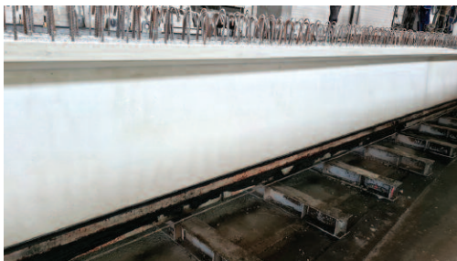
Fot. 1. Belka T spełniająca wymagania betonu architektonicznego BA2
