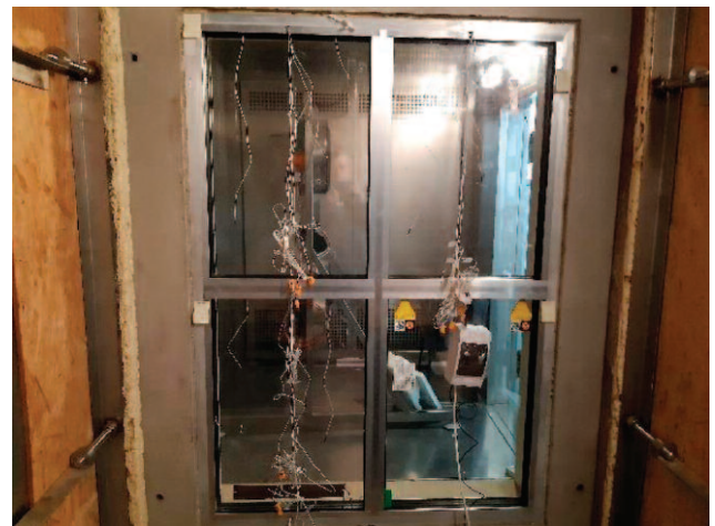
Fot. 1. Przegroda z badanymi zestawami szybowymi Photo 1. Partition with tested double glazing
