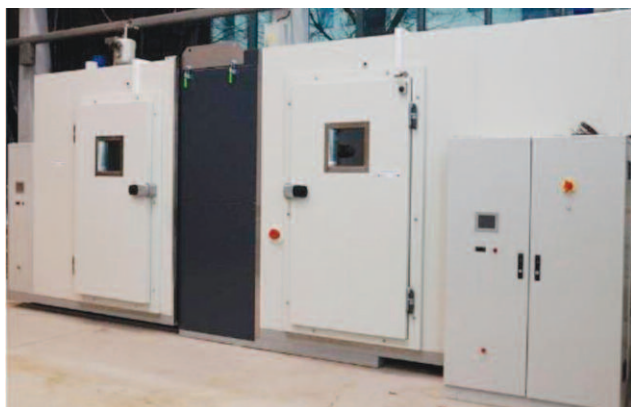
Fot. 2. Komora klimatyczna do badań przegród pełnowymiarowych
