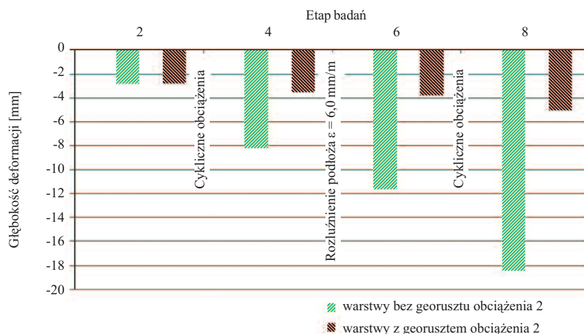
Rys. 5. Deformacja na powierzchni układu warstw pomierzona po wtórnym obciążeniu płytą statyczną
