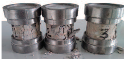
Fot. 3. Odwierty rdzeniowe po próbie ściskania
