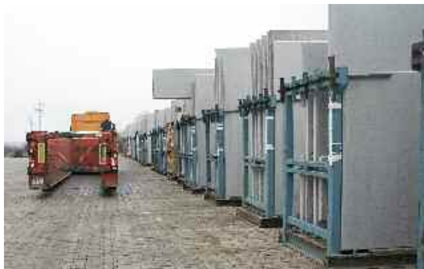
Fot. 3. Prefabrykaty podwójnej ściany FILIGRAN przygotowane do wysyłki
