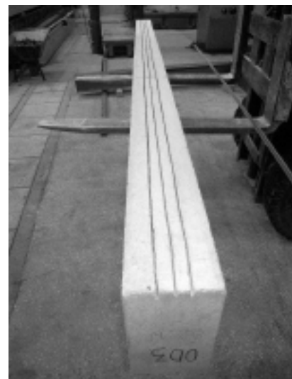
Bruzdy wycięte w belce w celu wklejenia prostopadłych taśm CFRP Fot. E. Kusa
