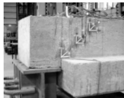
Fot. 3. Tensometry na powierzchni betonu
