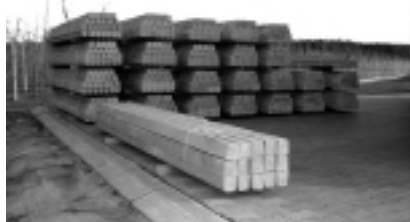
Fot. 4. Słupki strunobetonowe spięte w pakiety
