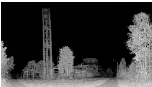
Chmura punktów pozyskana z jednego ze stanowisk skanera
