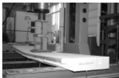
Fot. 2. Zginanie płyty momentem dodatnim
