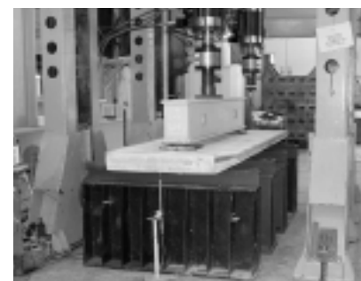
Fot. 1. Widok stanowiska do badań wytrzymałości płyt na zginanie
