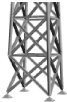
Rys. 2. Uwzględnienie w obliczeniach usunięcia dolnego krawężnika
