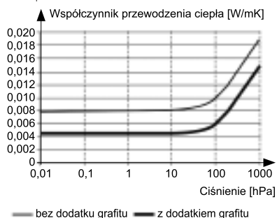
Rys. 2. Zależność współczynników przewodzenia ciepła granulatu aerożelowego od ciśnienia [4]
