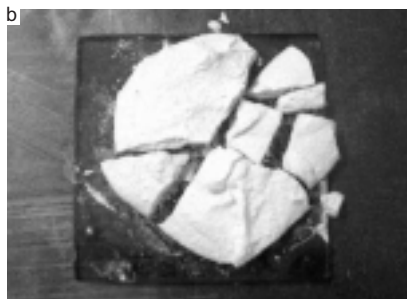
Fot. 2. Zmiana objętości materiału zarobionego wodą przyczyną destrukcji próbek ze spalania tekstury w temperaturze 750 °C: a – materiał zarobiony wodą po wstępnym gaszeniu; b – materiał niepoddany procesowi gaszenia
