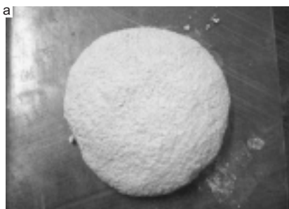
Fot. 2. Zmiana objętości materiału zarobionego wodą przyczyną destrukcji próbek ze spalania tekstury w temperaturze 750 °C: a – materiał zarobiony wodą po wstępnym gaszeniu; b – materiał niepoddany procesowi gaszenia
