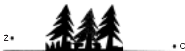
Rys. 3. Ekranujące działanie zieleni [wg I. Żuchowicz-Wodnikowska „Emisja i propagacja hałasu przemysłowego w środowisku zewnętrznym”, Wydawnictwo ITB, 2008 r.]
