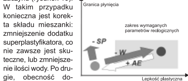
Rys. 10. Korekta wpływu domieszki AE na właściwości reologiczne mieszanki betonowej
