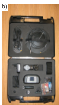
Fot. 5. Wibrometr laserowy z lunetą celowniczą (a) i system do badania wpływu drgań na ludzi (b)
