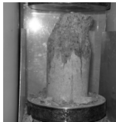
Fot. 2. Próbką walcową \varnothing 150 \times 300 mm po zniszczeniu
