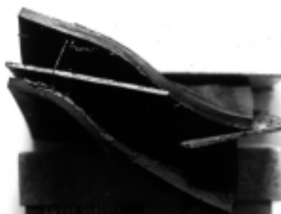
Fot. 3. Zbrojona podkładka elastomerowa po pęknięciu przekładki stalowej
