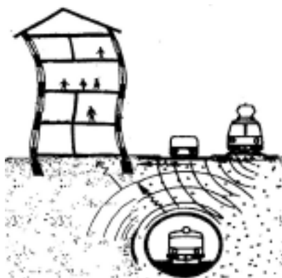
Rys. 1. Przenoszenie się drgań komunikacyjnych na budynek
