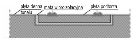
Rys. 16. Schemat nawierzchni kolejowej z trójstopniową wibroizolacją (podkładka w węzle mocującym szynę, podpora blokowa w otulinie, pływająca płyta podtorowa)
