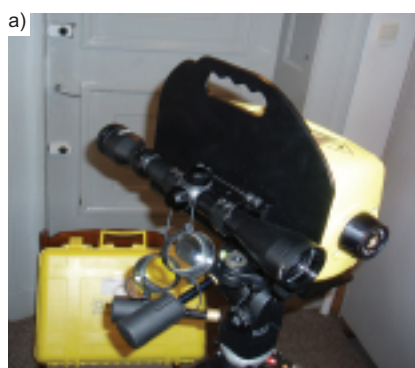
Fot. 5. Wibrometr laserowy z lunetą celowniczą (a) i system do badania wpływu drgań na ludzi (b)
